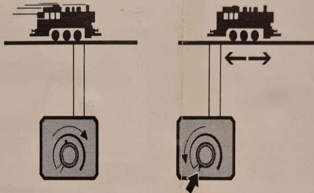
H0-Lokomotiven fahren in der Regel erst an, wenn der Drehknopf des Fahrgerätes 6699 fast die Mittelstellung erreicht hat.
